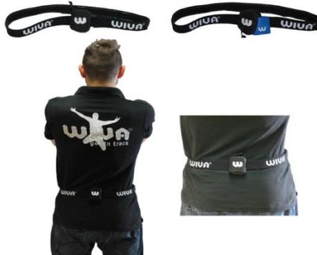
Figura 8: La figura rappresenta il punto corretto in cui posizionare l'accelerometro.
